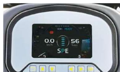
Modo de operação com três níveis (PES), permitindo ao operador selecionar diferentes velocidades de trabalho conforme a aplicação. A função opcional de controle da velocidade de direção auxilia na redução do risco de tombamento lateral.
