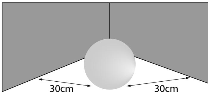
Deve ter um espaçamento de no mínimo 30 centímetros entre a máquina e qualquer outro objeto.
