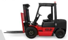
ALTURA MÁX DE ELEVAÇÃO 4500 MM CAPACIDADE DE CARGA DE TRABALHO 3000 KG
